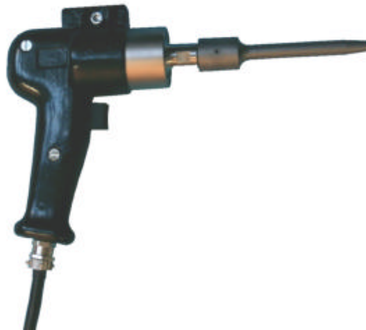
Handsweißgerät SP340, Schallkopf SH640 und Titan-Sonotrode
